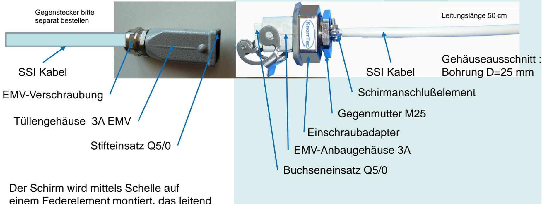
Der Schirm wird mittels Schelle auf einem Federelement montiert, das leitend mit den Gehäuseteilen verbunden ist.
